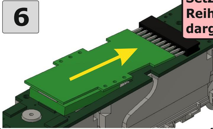
**Setzen Sie den Adapter in umgekehrter Reihenfolge wie in Abbildung 3 dargestellt in die Hauptplatine ein.**
