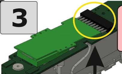
Lösen Sie den Adapter von der Hauptplatine:
