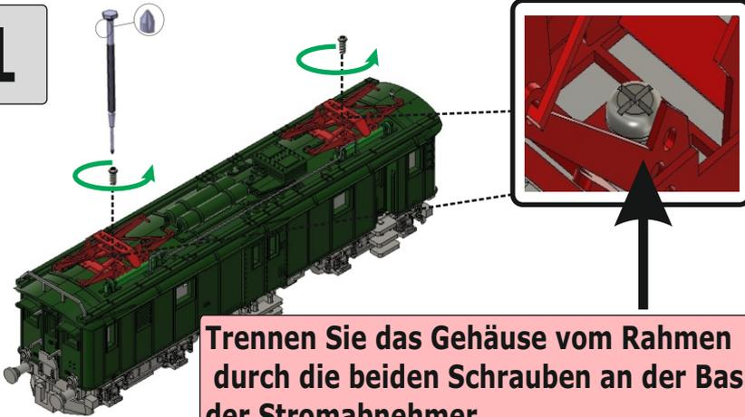
Trennen Sie das Gehäuse vom Rahmen durch die beiden Schrauben an der Basis der Stromabnehmer
