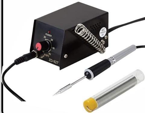
Verrà utilizzato per saldare i cavetti che portano la corrente dai carrelli motore e carrello centrale al circuito stampato principale della macchina.
