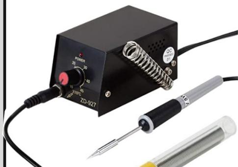
Verrà utilizzato per saldare i cavetti che portano la corrente dai carrelli motore e carrello centrale al circuito stampato principale della macchina. Alcune saldature se realizzate con un saldatore troppo potente potrebbero danneggiare alcune parti in plastica pertanto si consigliano saldatori di potenza ridotta (consigliato 15-20W).
