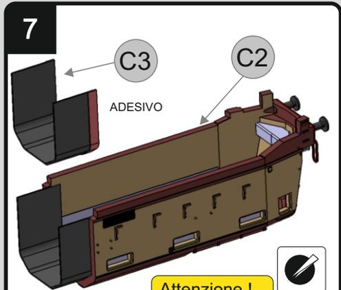
Fase 5, Applicazione degli adesivi interno macchina vengono applicati in modo da coprire tutti i finestrini laterale della macchina ad esclusione di quelli laterali cabina.
